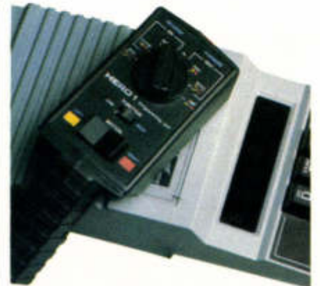
La télécommande permet uniquement les déplacements du robot.
